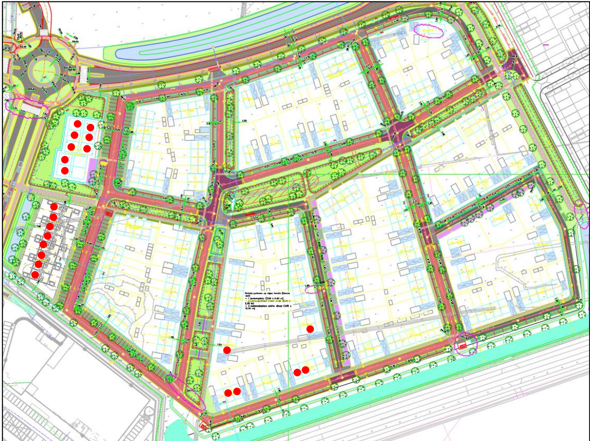
14 grondgebonden woningen en maximaal 27 appartementen, die geen geluidsluwe gevel hebben
