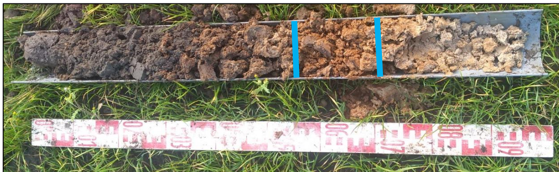
Afbeelding 14: Boring 98 met gescheiden door de blauwe lijnen v.l.n.r. de geroerde bovengrond, de zwak ontwikkelde oranje B-horizont en het lichtgrijze dekzand met roestvlekken
