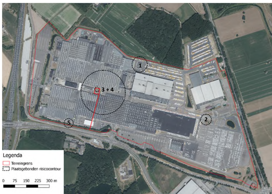
Figuur 2.1 Relevante installaties vanuit externe veiligheid binnen de huidige inrichting. Risicokaart (luchtfoto 2018). Nummer 5 1 betreft de locatie van de opslag en verlading van koudemiddel R1234YF
