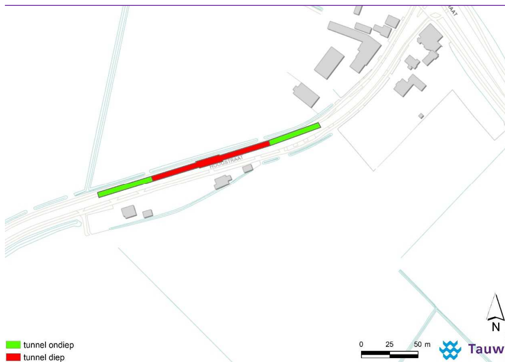
Figuur B3.7 Onderverdeling fietstunnel
