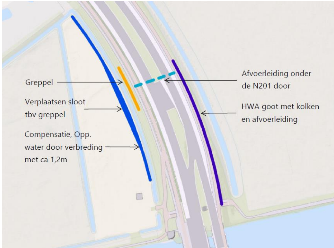
Afbeelding 3.5 Principe compensatie peilvak Cruquiusweg
