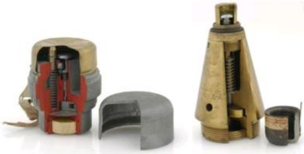
Figuur 83: Voorbeelden schokontstekers
