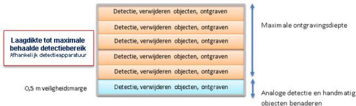
Figuur 40: Schematische weergave werkmethode laagsgewijze oppervlakedetectie
