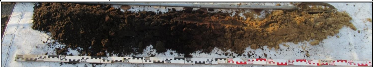
Foto: profielboring 4 m aan noordzijde boom 418
