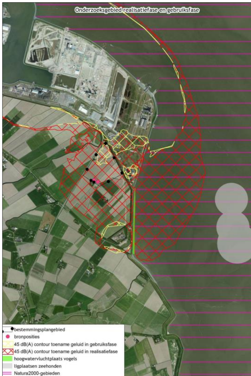
Figuur 66 Invloedsgebied geluidemissie ( 45 \text{ dB(A)} L_{Amax} ) tijdens realisatie- en gebruiksfase. Ontleend aan BugelHajema, 2013
