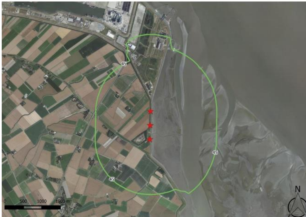
Figuur 21 45 dB(A) contour maximale geluidsniveaus L_{Amax} – Heien van vibropalen met mantel. Bron: LBP Sigt, 2015
