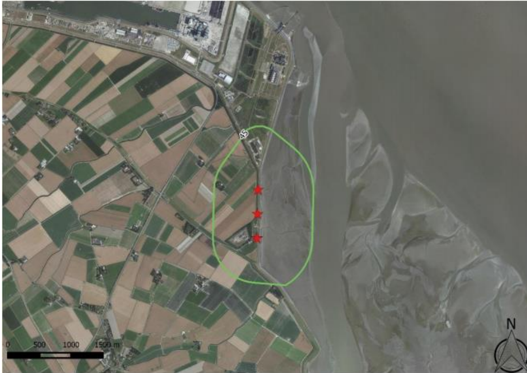
Figuur 23 . Tijdgemiddelde 45 dB(A) contour LAeq,12h. - Heien met mantel en vrachtwagenactiviteiten op één dag Bron: LBP Sight, 2015a
