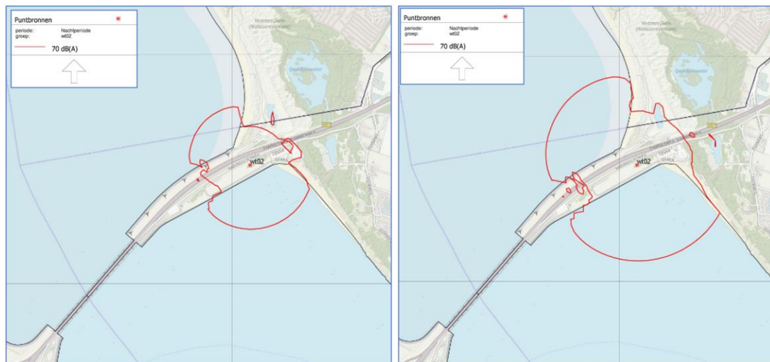
Afbeelding 5.2: Geluidscontouren voor het heien van funderingspalen van beton (links) en staal (rechts) voor windturbine (HVD2).
