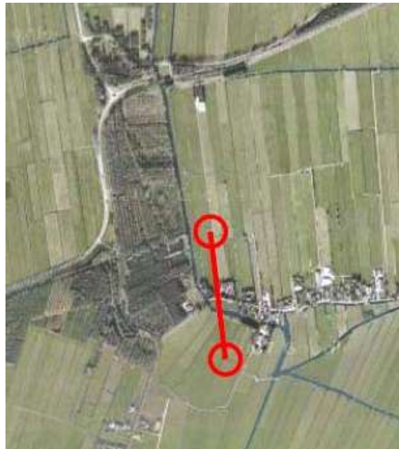
Het intredepunt en het uittredepunt van de HDD ter hoogte van het Westeinde
