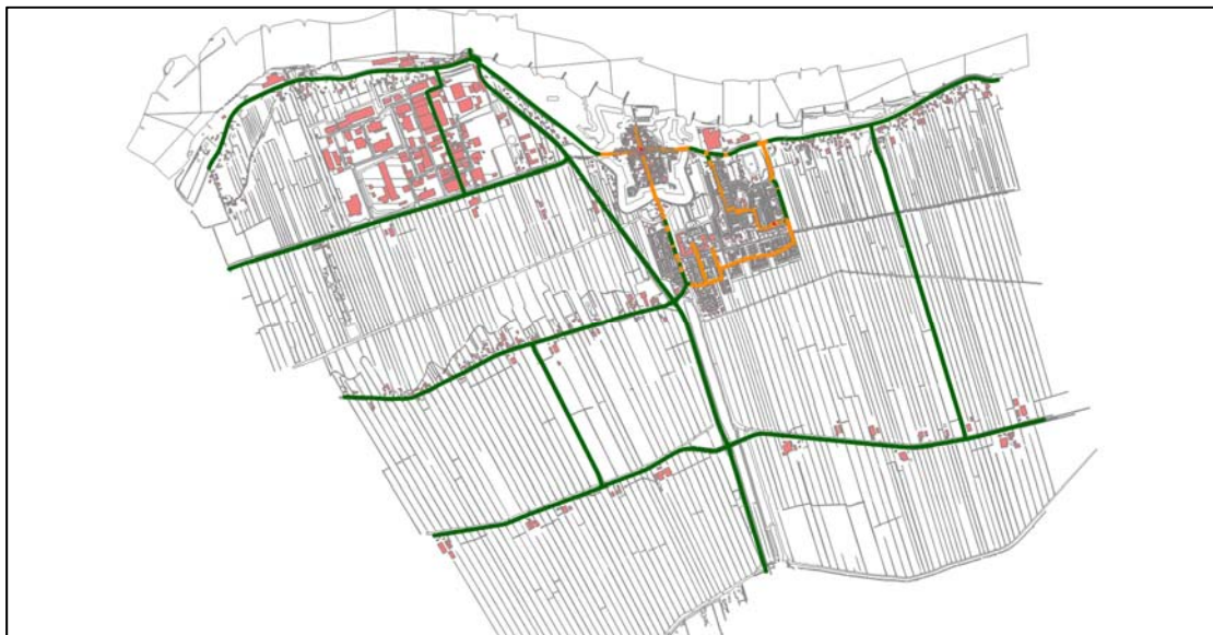
Figuur 3 Aanwezige en toekomstige verhardingen: groen - referentiewegdek (standaard asfalt), oranje - elementenverharding (klinkers) in keperverband en rood - elementenverharding (klinkers) niet in keperverband
