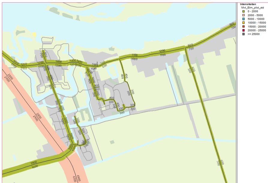
Figuur 3.4: Intensiteiten in motorvoertuigen per etmaal referentiesituatie 2030
