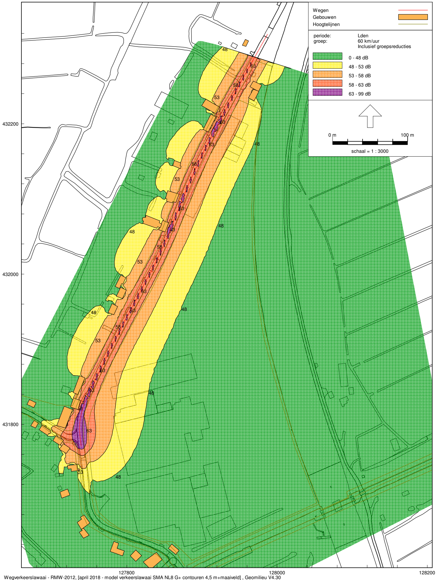
Geluidcontouren Bazeldijk op 4,5 meter+ maaiveld bij aanleg SMA NL8 G+ ten noorden van de kruising Dorpsweg
