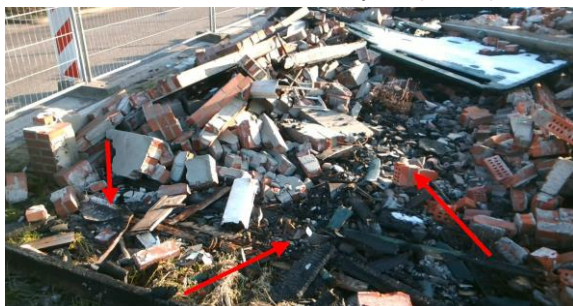
Foto 3. Asbesthoudende restanten plaat (bron 1)
