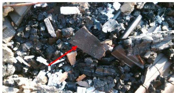
Foto 4. Asbesthoudende restanten plaat (bron 1)
