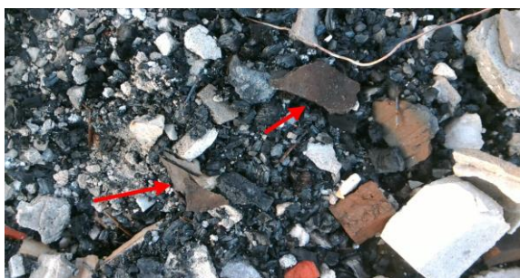
Foto 7. Asbesthoudende restanten plaat (bron 1)
