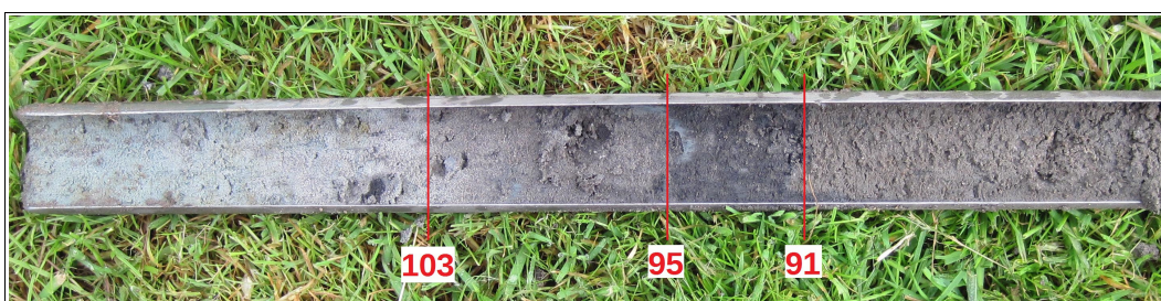
Figuur 5: Zuidhorn, Gaickingalaan: gutsmonster boring 2 van 80 tot 115 centimeter. Tussen 91 en 103 centimeter ligt zand met daarin fijne kleilagen en houtskoolspikkels. Het bovenste deel (91-95 cm) is humeus. Onder de zandlaag (links) ligt keileem, op de zandlaag (rechts) ligt homogene, humeuze klei dat een oude bouwvoor lijkt te zijn van voor de ophoging van het terrein.
