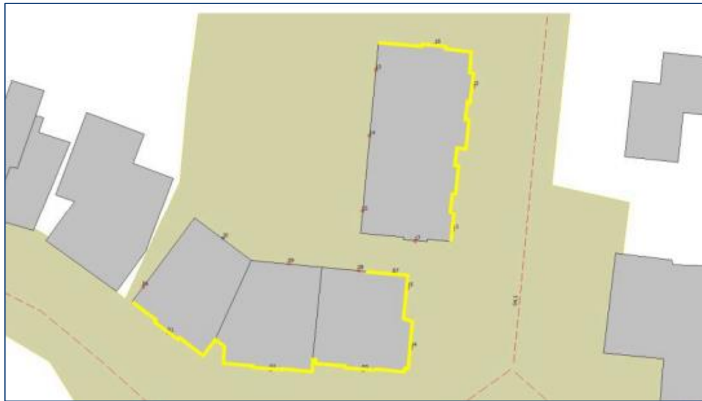
Fig. 4.6: Een weergave van de gevels (geel) die een geluidwering meer dan 20 dB (cf. Bouwbesluit 2012) nodig hebben.
