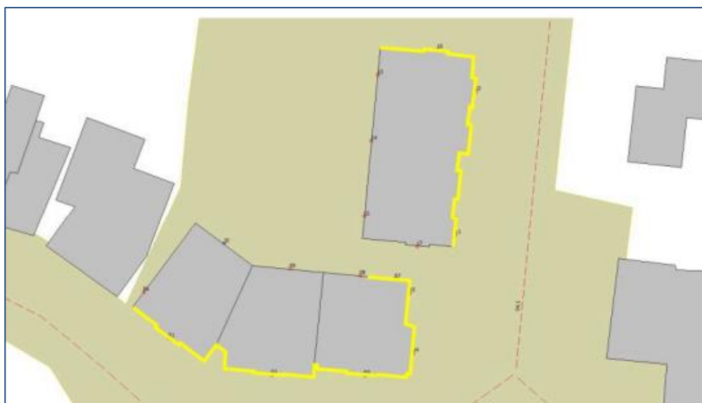
Fig. 4.5: Een weergave van de gevels (geel) die een geluidwering meer dan 20 dB (cf. Bouwbesluit 2012) nodig hebben.
