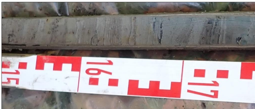
Afbeelding 3. Detail van boring 5: onregelmatig gelaagde getijdenafzettingen
