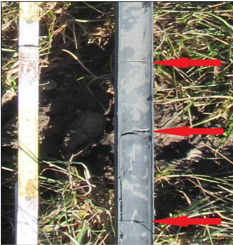
Afbeelding 13. Detail van boring 6. Zwartgrijze slib (geulvulling) met lichte vlekken, veroorzaakt door bodemleven (wormgangen)). De klei scheurt open op haarfijne zandlaagjes (aangegeven met een rode pijl).
