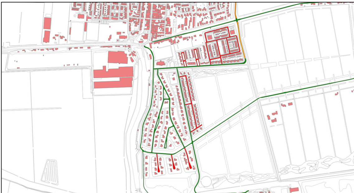
Afbeelding 5 Weergave wegvakken (oranje) met Dubofalt (dunne deklaag type B) op de Torensteelaan en referentiewegdek (groen) en elementenverharding in keperverband (rood)
