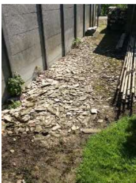
Asbestverdacht materiaal op maaiveld t.p.v. schuren
