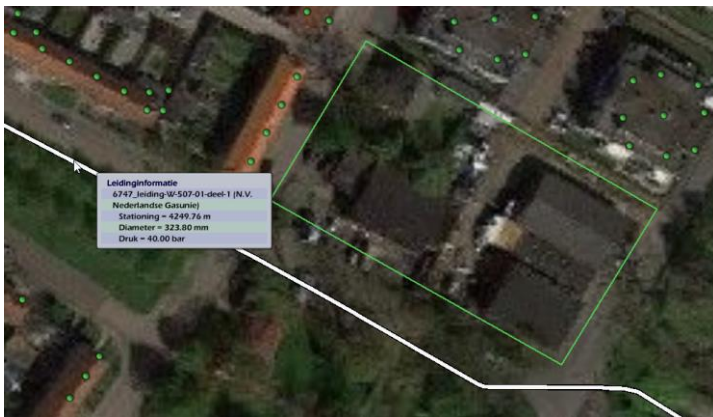
Figuur 3.6. Globale aanduiding ligging punt waar maximale overschrijdingsfactor is berekend voor de beoogde situatie incl. maatregel (halverwege tussen stationing 3750.00 en 4750.00, aangegeven met wit pijltje)
