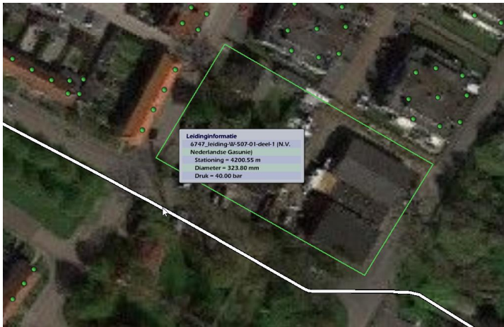
Figuur 3.5. Globale aanduiding ligging punt waar maximale overschrijdingsfactor is berekend voor de beoogde situatie (2,4 p) zonder maatregel (halverwege tussen stationing 3700.00 en 4700.00, aangegeven met wit pijltje)
