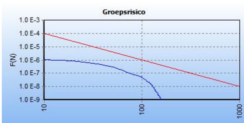
Figuur 3: FN curve huidige situatie voor 6340_leiding-W-507-01-deel-1 van N.V. Nederlandse Gasunie voor de kilometer tussen stationing 3700.00 en stationing 4700.00 (bron: Bron: 1901b Rapportage QRA hogedruk aardgastransportleiding Oranjestad)
