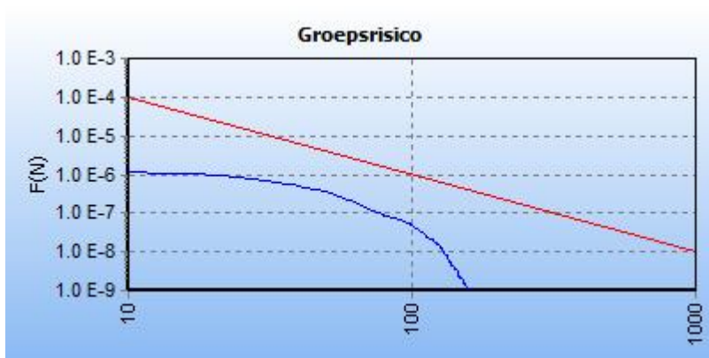
Figuur 4: FN curve beoogde situatie voor 6340_leiding-W-507-01-deel-1 van N.V. Nederlandse Gasunie voor de kilometer tussen stationing 3710.00 en stationing 4710.00 (bron: Bron: 1901b Rapportage QRA hogedruk aardgastransportleiding Oranjestad)
