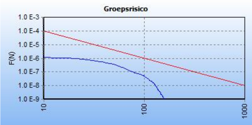
Figuur 8: FN curve beoogde situatie voor 6340_leiding-W-507-01-deel-1 van N.V. Nederlandse Gasunie voor de kilometer tussen stationing 3710.00 en stationing 4710.00
