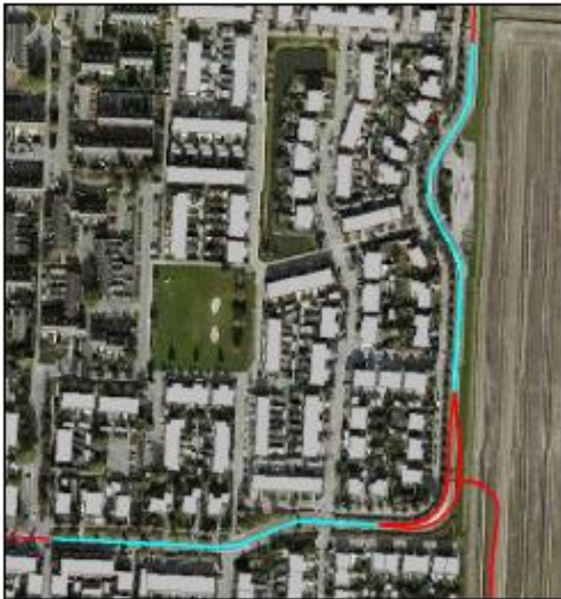
Figuur 4.5: Locaties op de Wethouder van der Veldenweg waar geluidsreducerend asfalt gerealiseerd kan worden om de geluidstoename weg te nemen
