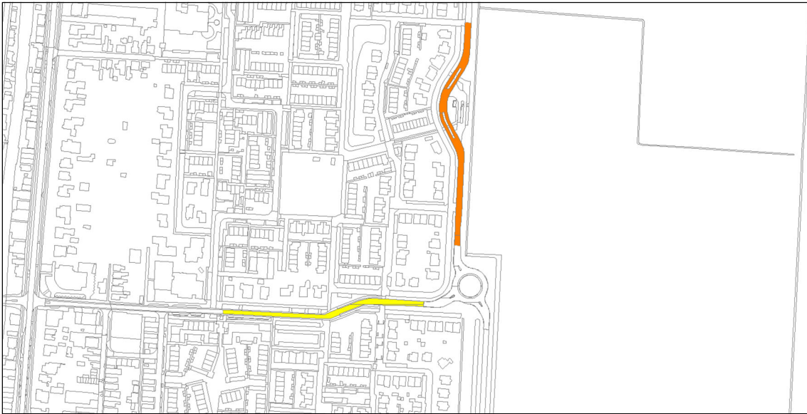
Figuur 8 Weergave wegvak met aan te leggen stil wegdek bestaande uit Redufalt (geel) en Dubofalt (oranje) op de Wethouder van der Veldenweg
