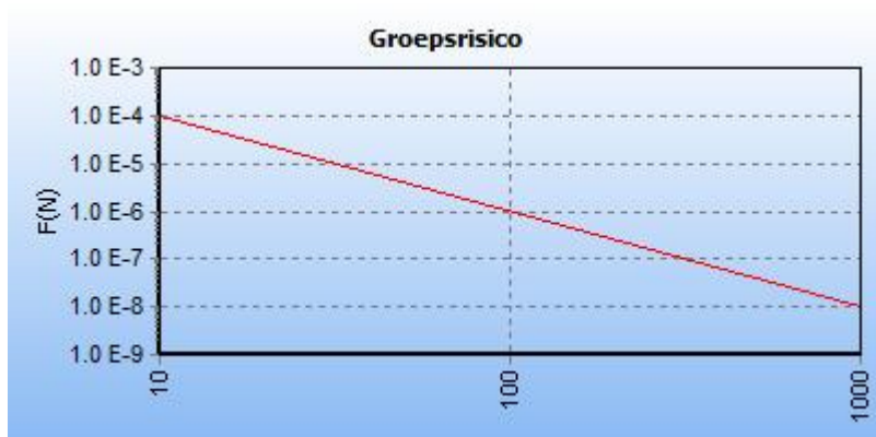
5.4 Figuur 5.4 FN curve voor 7335_leiding-W-524-01-deel-1 van N.V. Nederlandse Gasunie voor de kilometer tussen stationing 0.00 en stationing 1000.00
