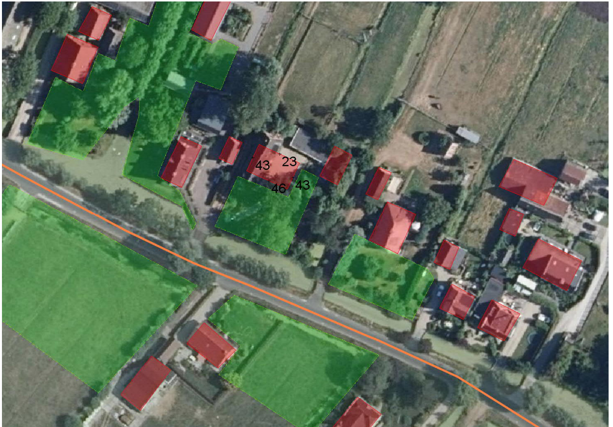
Figuur 3: geluidbelasting ten gevolge van de Middelkoop, hoogste waarde per waarneempunt, inclusief aftrek art. 110g
