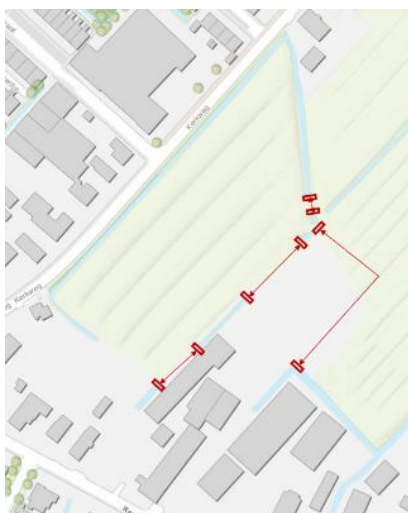
Figuur 4 De watergangen dienen door afdammen gerealiseerd te worden.
