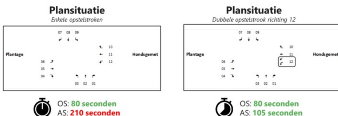
Figuur 2.4. Cyclustijden bij enkele opstelstroken (links) en een dubbele opstelstrook voor richting 12 (rechts) in de plansituatie
