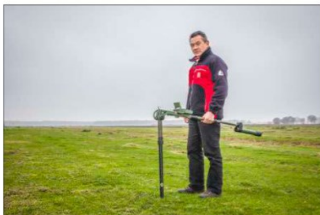
Figuur 8. Passieve realtime oppervlakedetectie met een Vallon VX1 Magnetometer en een staafdiagram waarop het maximale detectiebereik (m³ - maaiveld) per kaliber.
