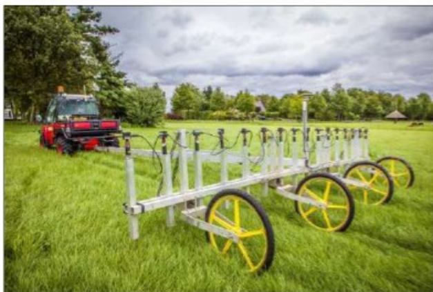
Figuur 4. Passieve non realtime oppervlakedetectie met het Vallon Multisondesysteem VXV16 en een staafdiagram waarop het maximale detectiebereik (m² – maaiveld) per kaliber.
