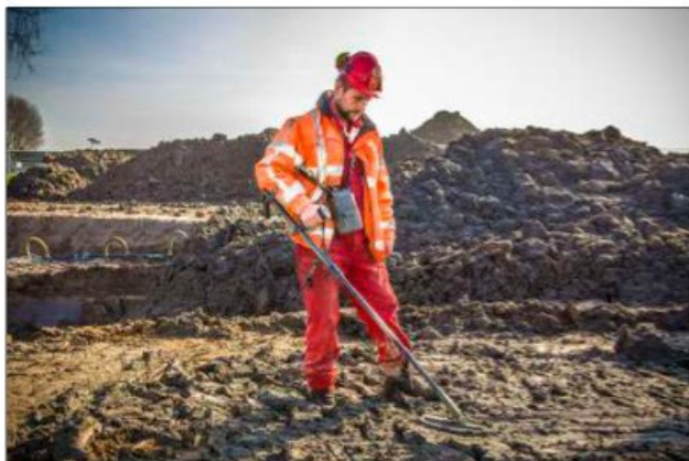
Figuur 10. Uitvoeren actieve realtime oppervlakedetectie en een staafdiagram waarop het maximale detectiebereik (m 3 - maaiveld) per kaliber.
