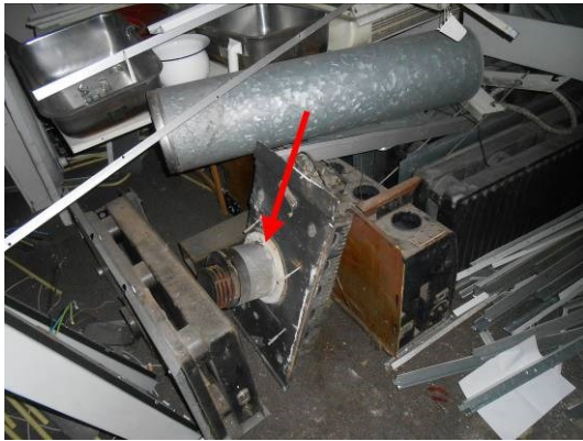
Foto 17 | Benraad gevelkachel met asbestvrij koord.
