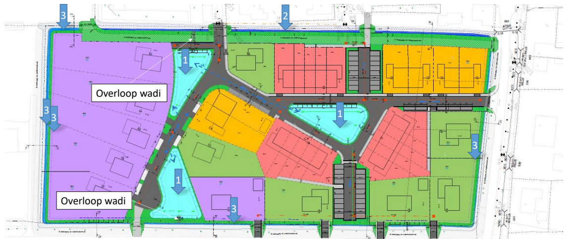
Figuur 2-2: Schets en locatie bergende voorzieningen
