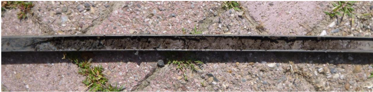
Figuur 21: Foto van de sterk venige klei die op alle boorpunten onder het bovenste pakket komklei is aangetroffen.
