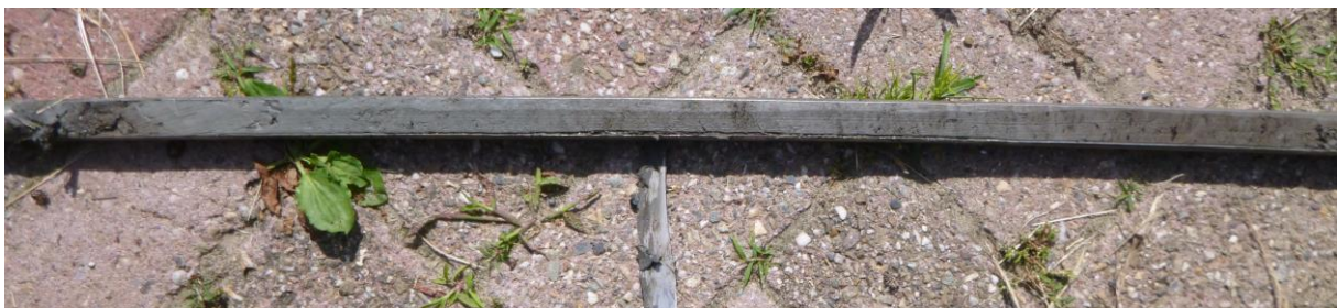
Figuur 22: Foto van de sterk zandige klei (bij de punt van het mes), die op alle boorpunten tussen 2 en 2,5 meter beneden het maaiveld is aangetroffen.
