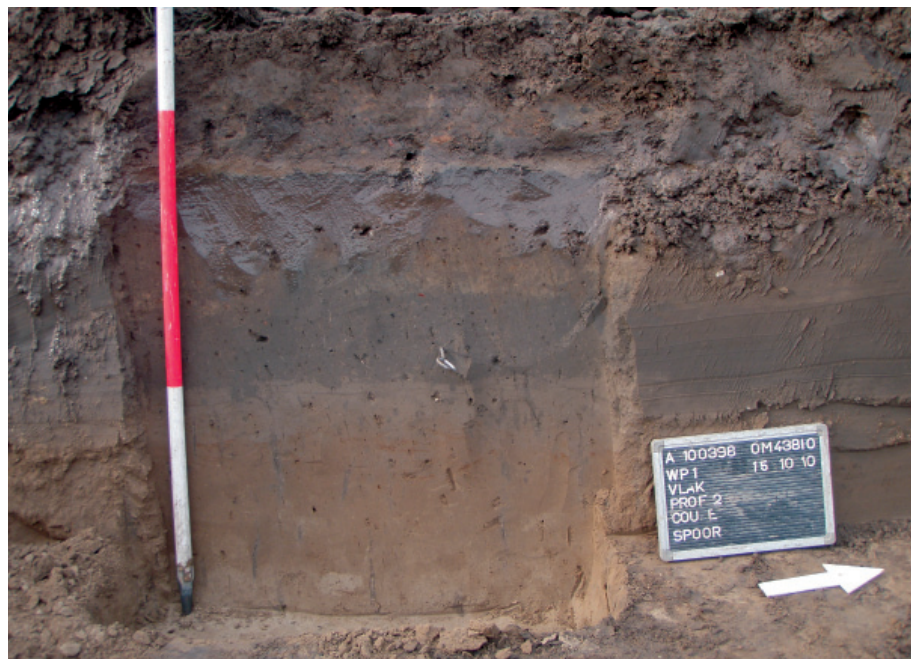
Afbeelding 3. Profiel 2 in werkput 1 gezien naar het westen, duidelijk zichtbaar zijn de bodemopbouw verstorende egalisatielagen boven de resterende B- en C-horizont.
