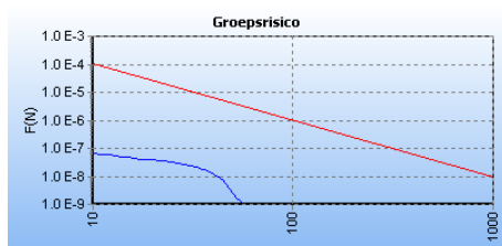
Figuur 5.5 FN curve voor A-523 van N.V. Nederlandse Gasunie voor de kilometer tussen stationing 76570.00 en stationing 77570.00
