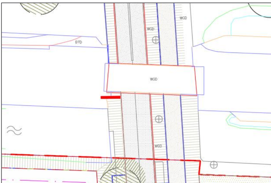
Figuur 7.4 Overwegboom trottoir voor spoorwegovergang
