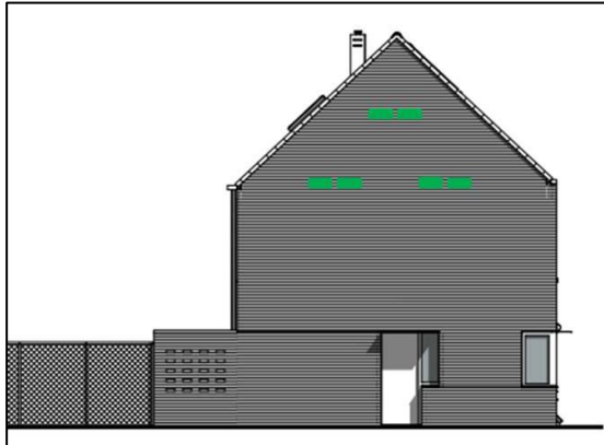
Figuur 11 Voorbeeld voor het inbouwen van vleermuisstenen in de gevel in groepjes van 2 naast elkaar.
