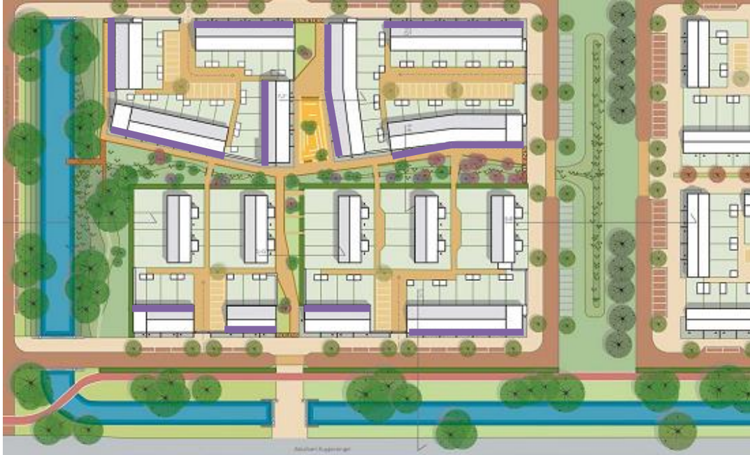
Figuur 1 Richtlijn voor het inbouwen van de vogelvides in fase 3. Met paarse lijnen is de voorkeurszijde per blok aangegeven.
