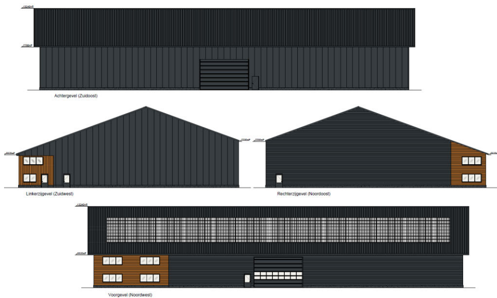
Figuur 8. Gevelaanzichten van de te bouwen bedrijfsloods
