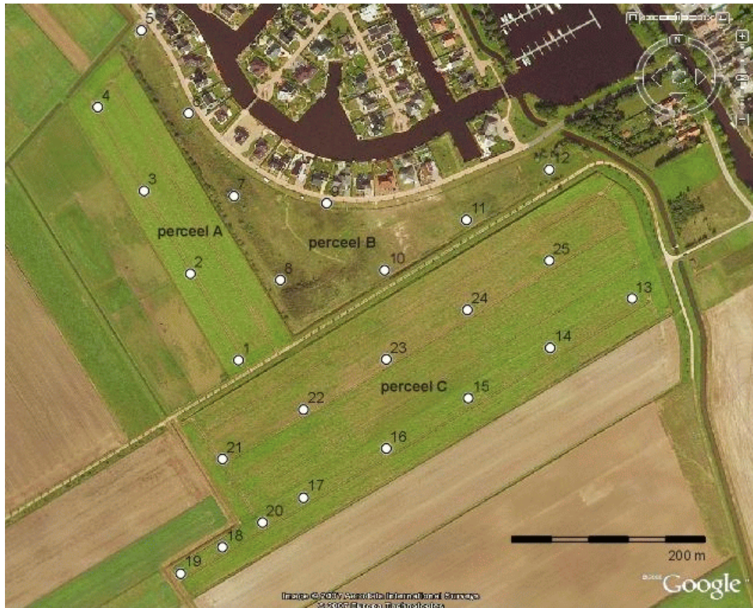
Figuur 5: Ter Apel: Rundedal 2 e fase, boorpuntenkaart met een luchtfoto als achtergrond. Ter plaatse van de genummerde punten zijn de boringen verricht.
