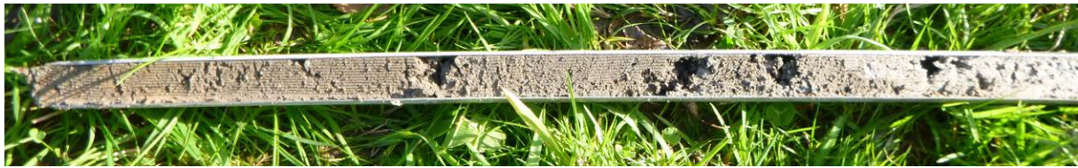
Figuur 7. Franeker, Marten Oostwoudstraat en Noorderbleek. Foto van de met deeltjes slooppuin vermengde toplaag.
