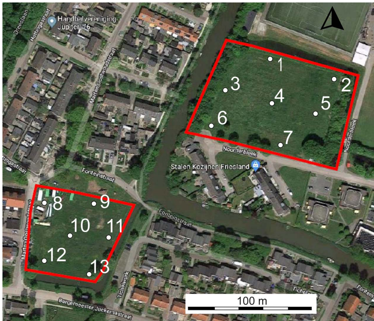
Figuur 6. Franeke, Marten Oostwoudstraat en Noorderbleek. Boorpuntenkaart. De genummerde punten geven de boringen weer. [Bron: Rho Adviseurs bv.]
