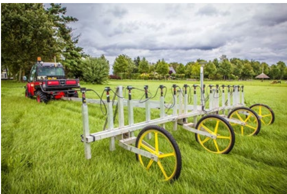
Figuur 15. Passieve NON realtime oppervlakedetectie: Vallon Multisondesysteem VXV16 gemonteerd achter een voertuig.
