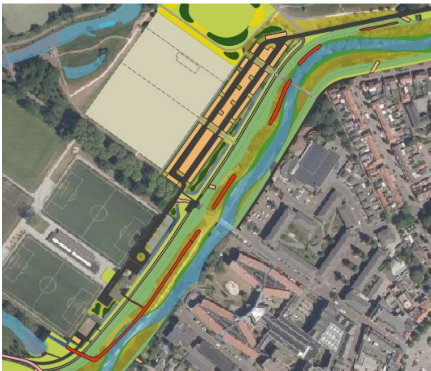
Figuur 4-2 Te dempen bestaande watergangen (in rood)
