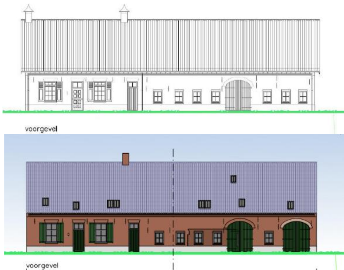
Figuur 2.2: Boven: de voorgevel van de woonboerderij in de huidige situatie. Onder: de nieuwe voorgevel van de woonboerderij (bron: Bureau voor architectuur aujourd'hui Boekel)
