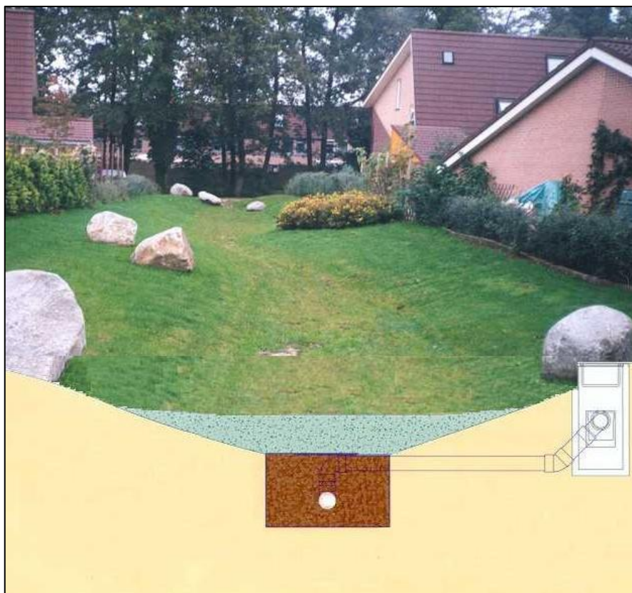
Afbeelding 6: principetekening wadi met slokop naar ondergelegen grindkoffer
