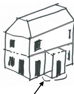
Voorbeeld 2: Gebouwdeel met goothoogte kleiner dan 3,5 meter en bouwhoogte kleiner dan 6 meter. In dit geval is het bouwdeel een aanbouw (of uitbouw) en gelden de regels voor die bouwdelen.
