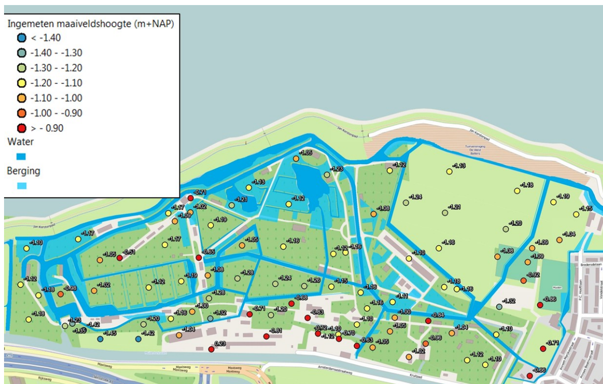
Figuur 7 Maaiveldhoogte op basis van waterpassing uit 2010 (de gegevens zijn geprojecteerd op een plankaart van een concept-ontwerp voor open water in het plangebied).
