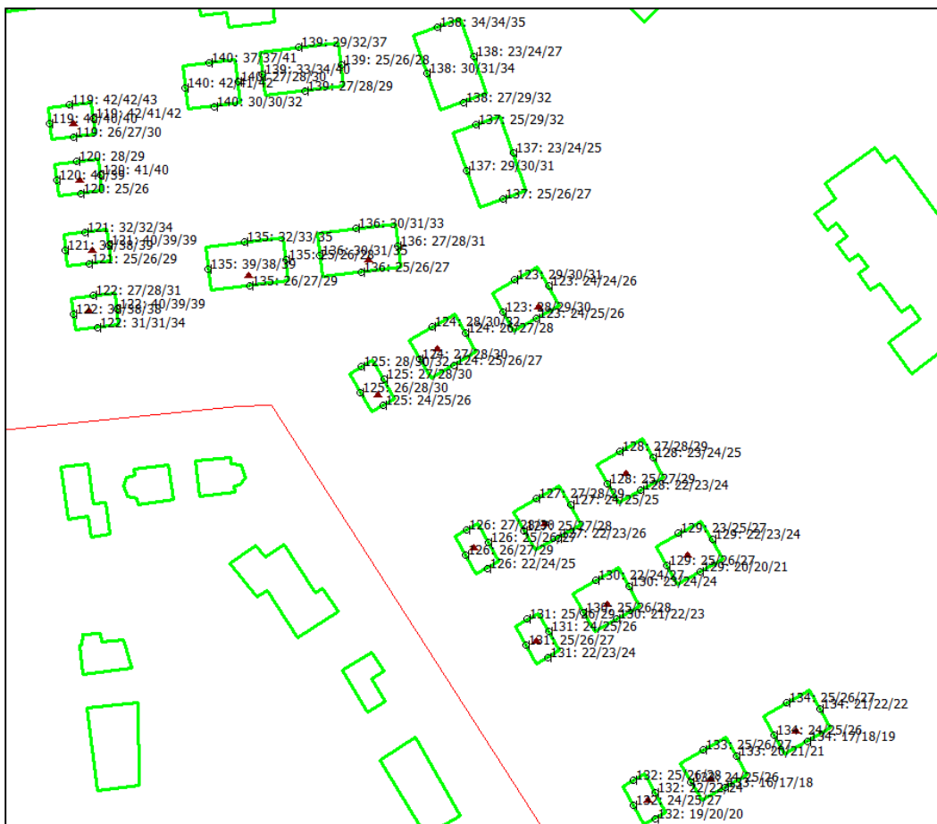
Figuur 4.3 Toetsingswaarde ( L_{den} ) in dB, door verkeer op de Godelindeweg, inclusief correctie conform art. 3.4 RMG 2012.
