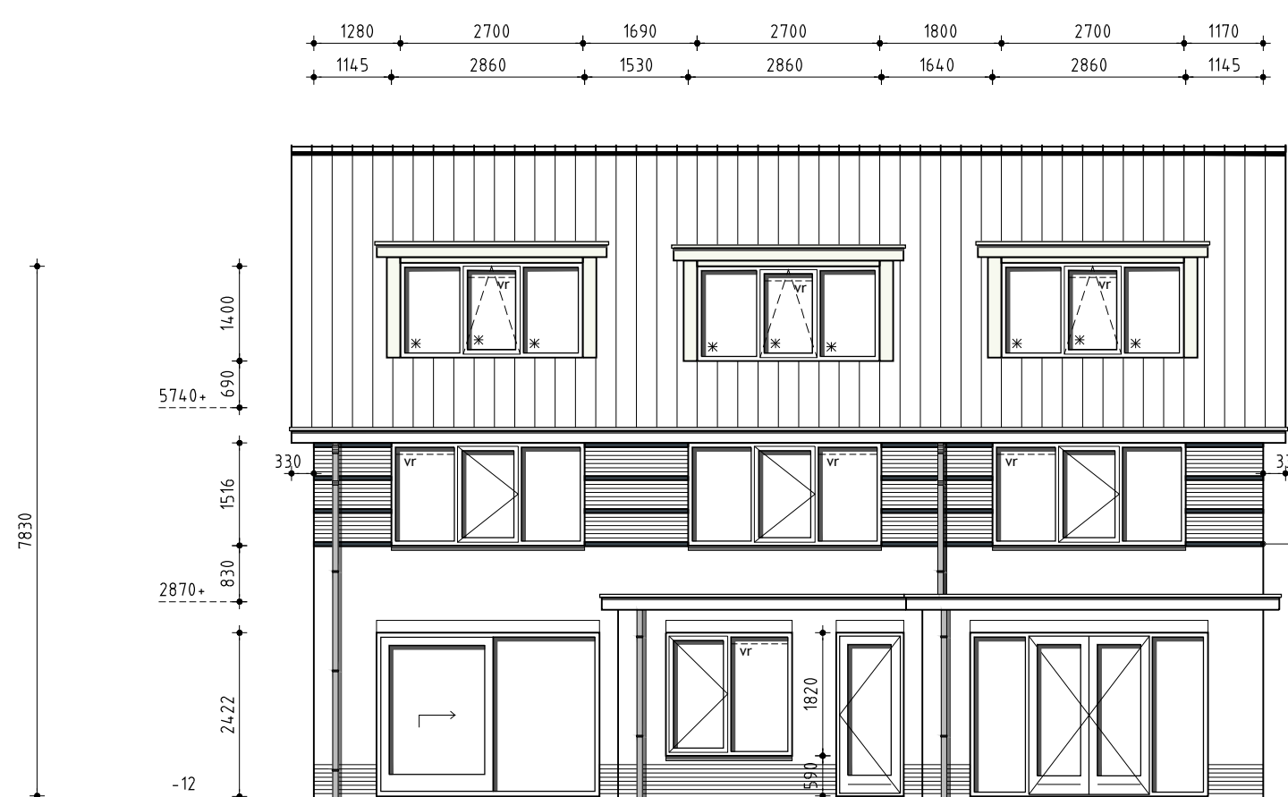
Achtergevel • v.v. vriesopbouw raam dakkapel in maximale stand maximaal 100mm te openen
