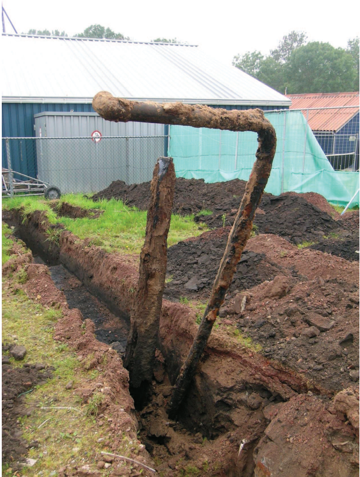
Foto 3: Leidingen met teer in sleuf 3.
